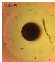
Neuwertige Düse: scharf definierte Wassereintrittskante
