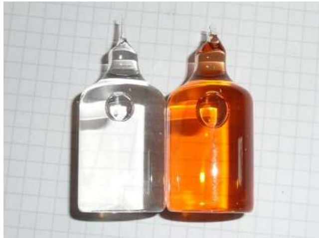
Abb.4: zwei Küvetten eines Eisen-Schnelltests, die bei einem Kunden an derselben Entnahmestelle gefüllt wurden; während der Woche (links) und am Montagmorgen (rechts). Die Intensität der Färbung zeigt den Eisengehalt an.
