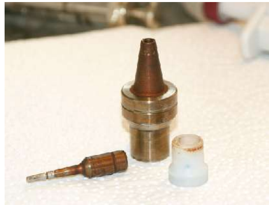
Abb.1: Ventil aus einer Hochdruckpumpe.
